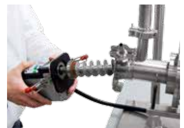
Шнековый транспортер с регулировкой скорости вращения
