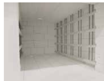
Защитная решетка перед нагревательными элементами для защиты от механических повреждений
