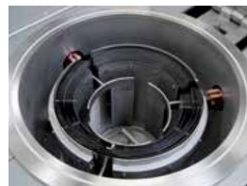
Цилиндрическая реторта с вольфрамовым нагревом
