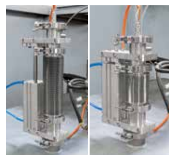
Термоэлемент типа S с автоматическим устройством выдвигания для точного управления в нижнем диапазоне температур
