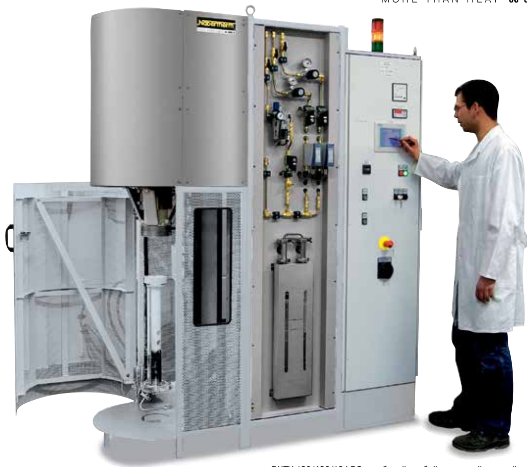
RHTV 120/480/16 LBS с рабочей трубой, закрытой с одной стороны, опцией для защитного газа и вакуума, а также электрическим шпиндельным приводом подъемного стола
