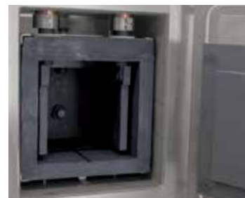
Графитовый нагревательный элемент
