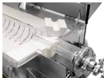
Переходники для эксплуатации попеременно с рабочей трубой или технологическим реактором
