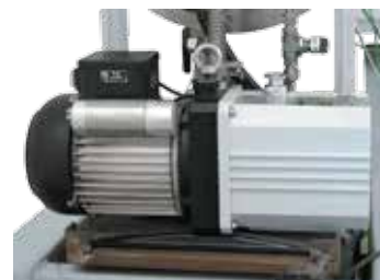
Вакуумный насос для холодного вакуумирования реторты
