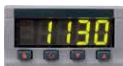
Регулируемый ограничитель температуры
