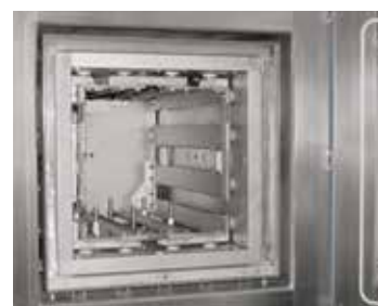
Вольфрамовый нагревательный элемент
