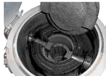
Графитовый нагревательный модуль
