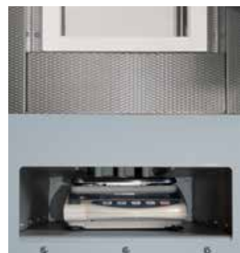
NT 16/17SW со взвешивающим устройством для определения потерь при прокаливании
